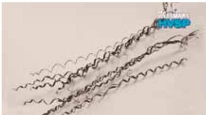
**Optimale Spanform bei HVSP Gewindeboher**
