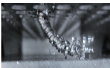
nicht ausreichender Platz für eine korrekte Spanabfuhr
