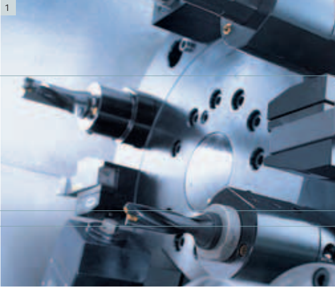
1| Schnell schaltender 12fach-Servorevolver 2| Hochgenaue Führungselemente 3| Bearbeitung mit Reitstockunterstützung 4| Präzisionsführungen im X-Schlitten
