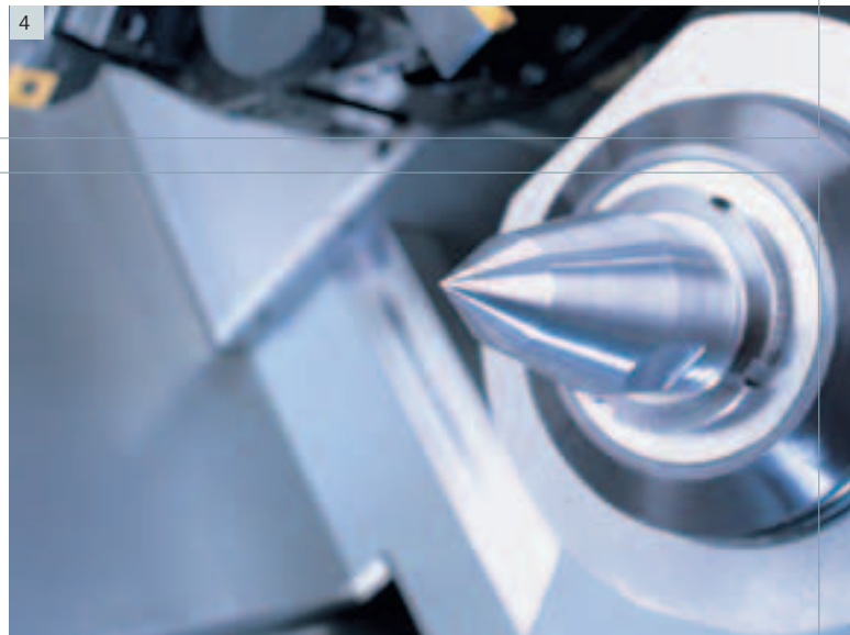
1| Nutenfräsen mit angetriebenen Werkzeugen 2| Rüstzeitverkürzung durch automatisches Werkzeugmesssystem 3| Y-Achse für außermittige Bohr- und Fräsoperationen aber auch für Flächen- und Nutenfräsen 4| Minimierte Nebenzeiten durch Reitstock mit zwei Verfahrensgeschwindigkeiten 5| Bearbeitung mit Lünette
